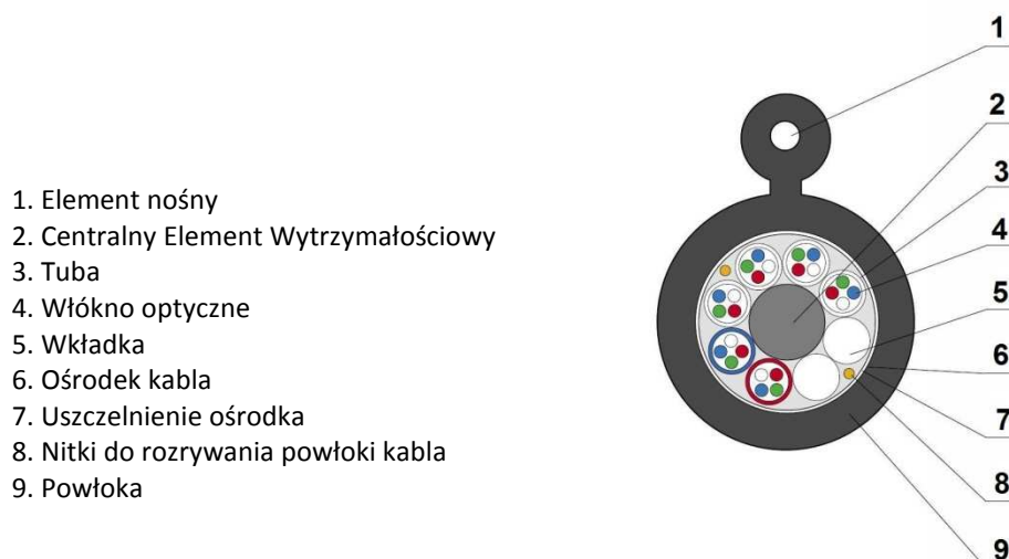
rys. 3. Budowa kabla ADSS z zewnętrznym elementem nośnym
